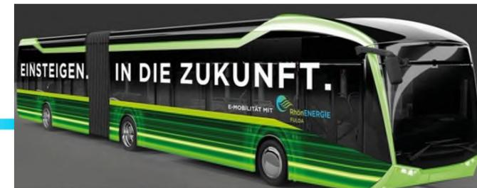
Etwa so wird der E-Gelenkbus aussehen, der ab dem Frühjahr 2018 die Linie 6 bedienen soll. Das in Sonderanfertigung gebaute Fahrzeug hat insgesamt 140 Plätze und eine Reichweite von bis zu 250 Kilometern. - Foto: Abb. RhönEnergie Fulda
